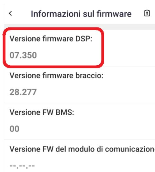
Al termine del processo di aggiornamento è possibile proseguire la configurazione di base dell'inverter rimanendo connessi con la chiavetta Bluetooth, oppure rimuoverla, collegare nuovamente l'antenna WiFi e collegarsi all'inverter tramite quest'ultima.
