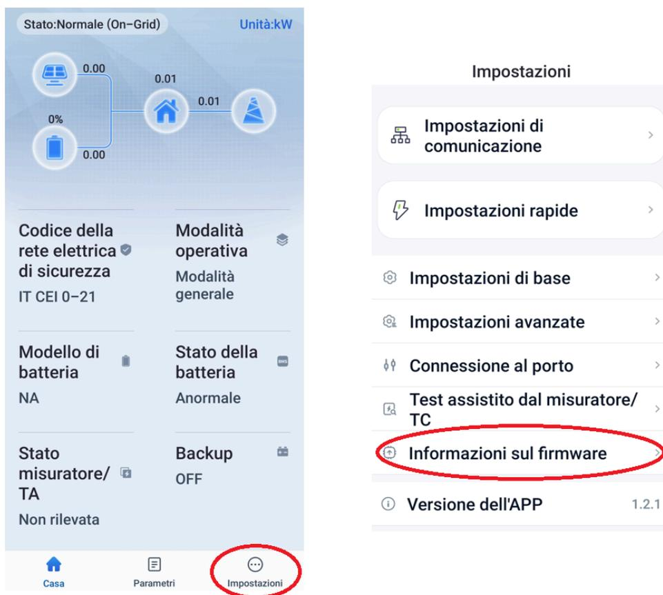
Selezionare "Versione firmware Braccio", l'applicazione rileverà la versione firmware installata nell'inverter e l'ultima disponibile.
