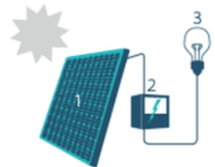
1. Zonnepaneel | 2. Omvormer | 3. Elektrische toestellen
