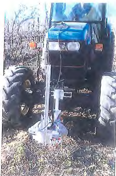
Un sensore di rilevamento della vigoria tramite la misurazione dello spessore dei tralci di vite. A destra il team della facoltà di Agraria di Milano presente allo stand "Meet me tonight"
