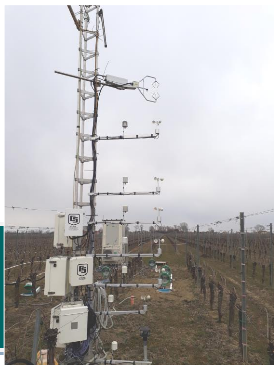
Una camera di monitoraggio (sx) e una stazione Eddy covariance (dx) installate presso due vigneti test
