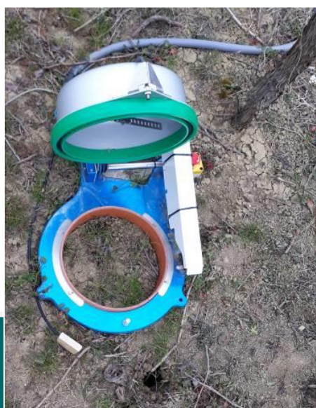
Una camera di monitoraggio (sx) e una stazione Eddy covariance (dx) installate presso due vigneti test
