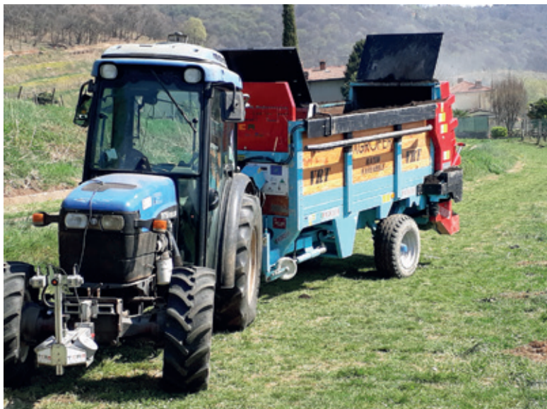
PROTOTIPO DI MACCHINA PER LA DISTRIBUZIONE DEL CONCIME ORGANICO A RATEO VARIABILE APPLICABILE IN VITICOLTURA: LA MACCHINA È STATA PROGETTATA PER DISTRIBUIRE "IN TEMPO REALE" ATTRAVERSO LA LETTURA EFFETTUATA CON IL SENSORE POSTO ANTERIORMENTE AL TRATTORE CHE COMUNICA CON IL CARRO
