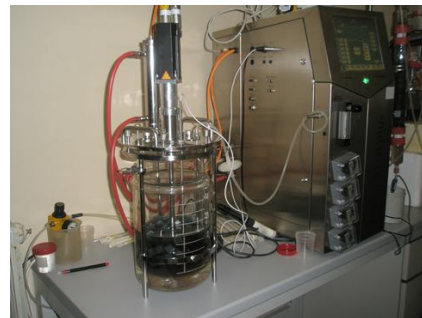
BIOREATTORE CON FUNGO IMMOBILIZZATO SU SUPPORTI DI POLIURETANO ESPANSO PER IL TRATTAMENTO DI REFLUI INDUSTRIALI (INDUSTRIA TESSILE)
