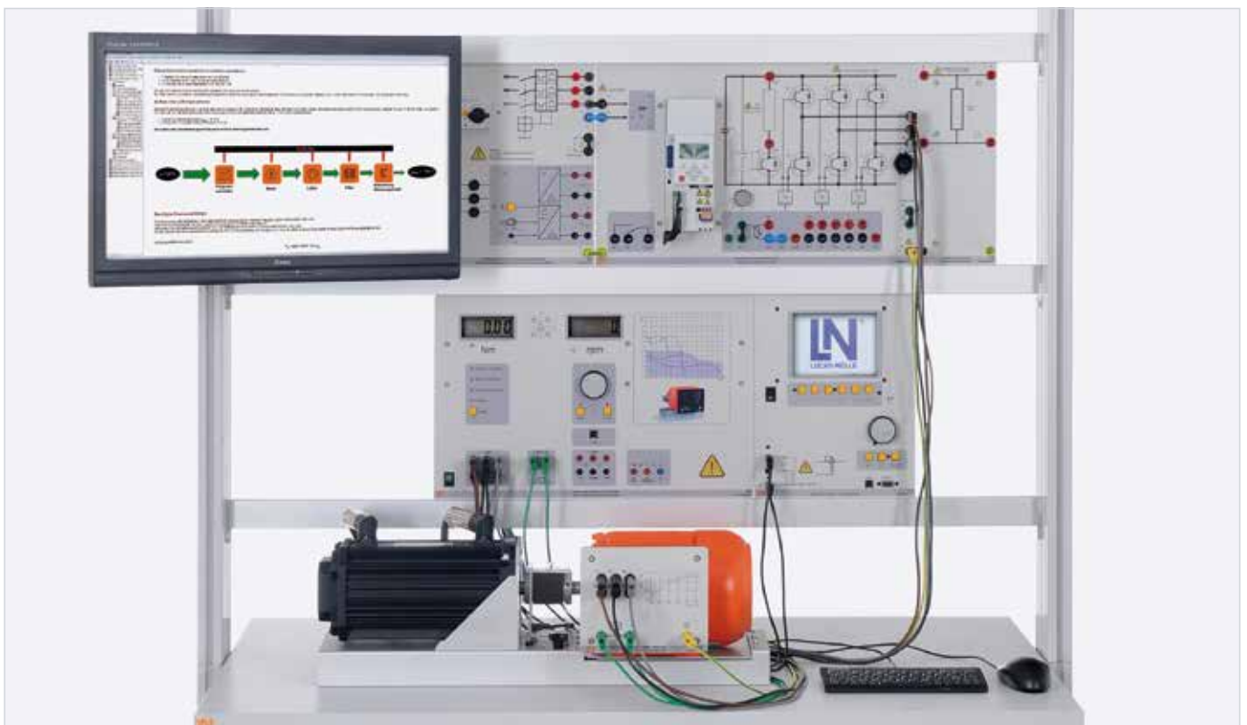
Trainingsystem „Energieeffiziente Antriebe mit Frequenzumrichtern“ bestehend aus Höchsteffizienzmotor, Frequenzumrichter und Servo-Maschinenprüfstand
