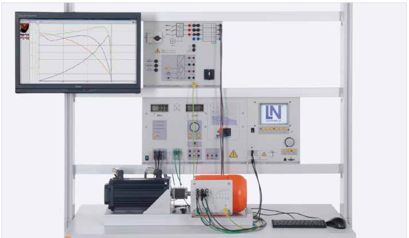
Trainingsystem „Energiesparmotor“ bestehend aus Höchsteffizienzmotor und Servo-Maschinenprüfstand.
