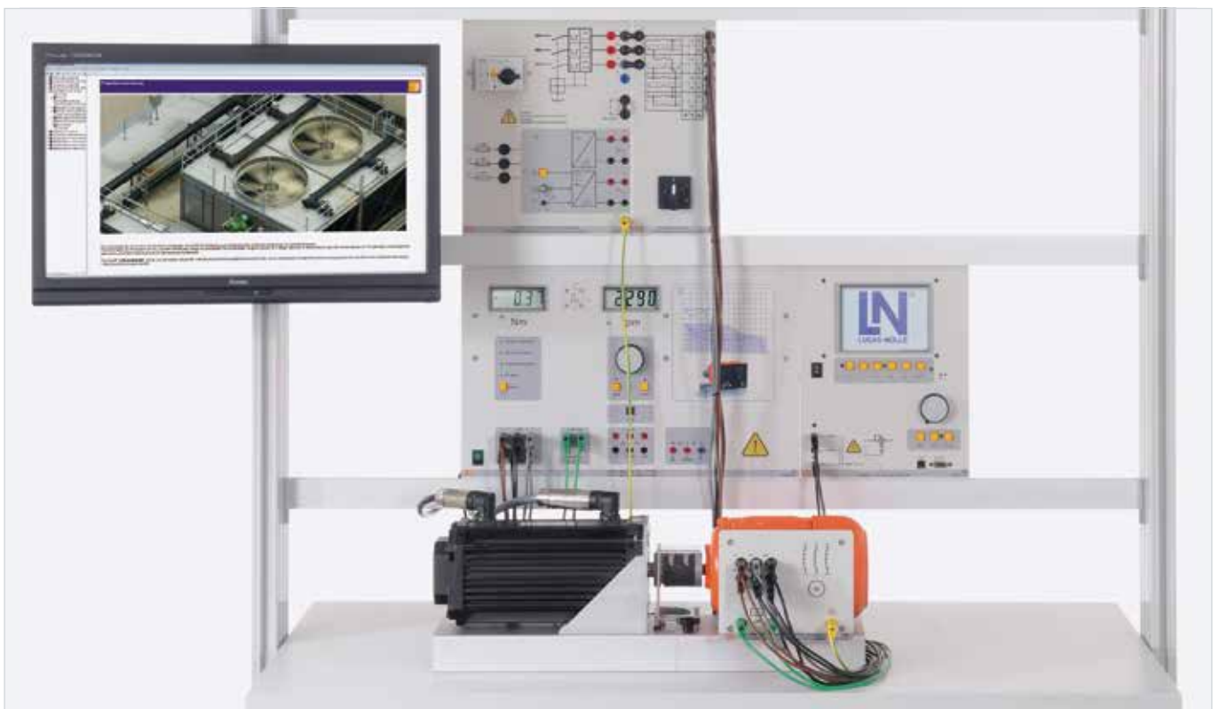
Trainingsystem „Energieeffiziente Antriebsauslastung“ bestehend aus Drehstromsynchronmotor und Servo-Maschinenprüfstand.
