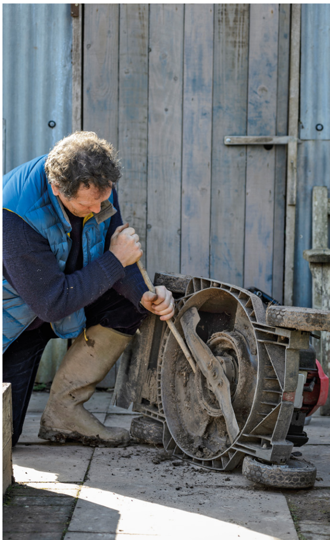
Verwijder aangekoekte modder en maaisel om te voorkomen dat het snijblad vastloopt.
