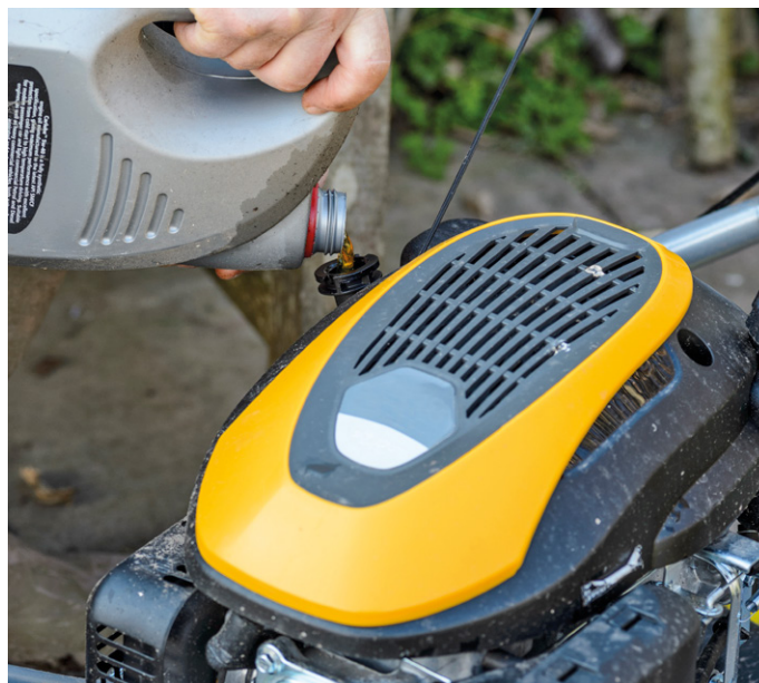
Controleer het oliepeil van een benzinemaaier en vul zo nodig olie bij.
