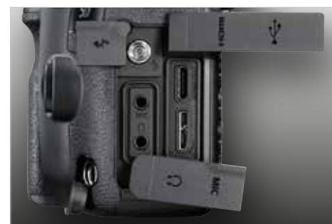
Aansluitingen voor de flitsynchronisatiekabel, microfoon, koptelefoon, USB 3.0, hdmi en een draadontspanner vind je aan de zijkant.
