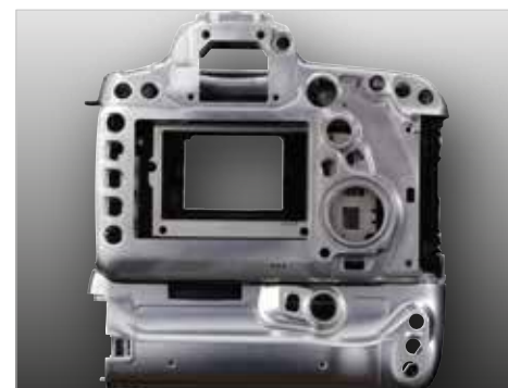
De camera en de accugreep (BG-E20, ca. 400 euro) bestaan uit een robuuste magnesiumlegering. In deze prijsklasse verwachten we ook niet anders.
