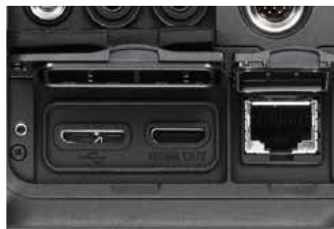
De gigabit-Ethernet- en USB 3.0-poort maken snelle dataoverdracht mogelijk. USB 2.0-kabels passen ook, maar zijn niet echt aan te bevelen.
