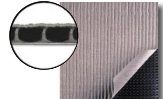
**Tenax DP1 (Drainage Protection)** è un prodotto che assolve contemporaneamente alle funzioni di filtrazione (passaggio di acqua attraverso uno strato permeabile), di drenaggio (allontanamento dell'acqua non appena filtrata) e di protezione meccanica ed antiradice del supporto impermeabilizzato.
