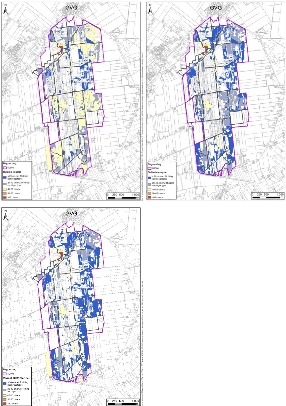
Figuur 3-10 Mate waarin de veenwaterstanden zouden voldoen aan de voorwaarden (GVG) voor vegetaties van herstellend hoogveen van matige kwaliteit die zich richting slenkvegetaties ontwikkelen (t.b.v. onderlinge vergelijking van varianten). Linksboven: huidige situatie, rechtsboven: Gebiedsanalyse, linksonder: variant 2022.
