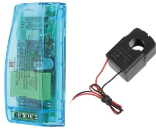
Bild 2. Der Sensor PZEM-004T mit Transformator.
