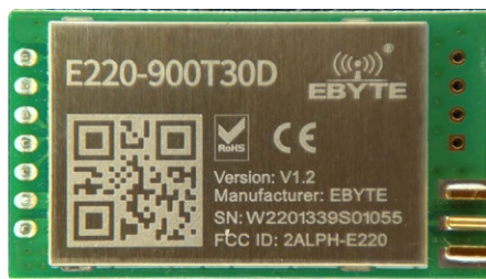
Bild 2. Das Modul E220-900T30D verfügt über einen 8-dB-Leistungsverstärker, der die Sendeleistung auf 30 dBm oder 1 W erhöht.
