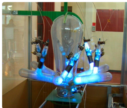
Bild 2. Ein Quecksilberdampf-Gleichrichter. Quelle: Wikipedia / Timberwind / Public Domain.
