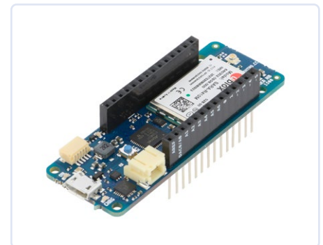
Bild 7. Modul Arduino MKR NB 15 für die Kommunikation in Netzwerken des Narrowband IoT.
