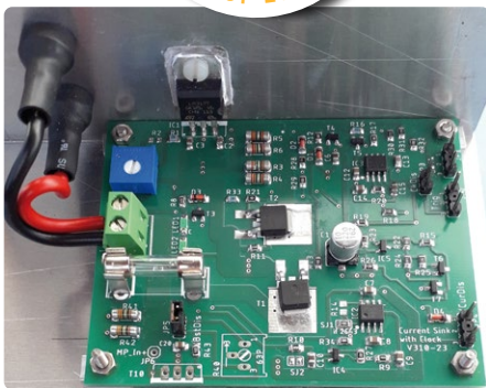
Bild 1. Die Stromsenke ohne Booster mit großem Kühlblech (links). Die Kunststoffschraube am LM317 war keine gute Idee. Die voll ausgebaute Schaltung mit Booster ist rechts zu sehen.
