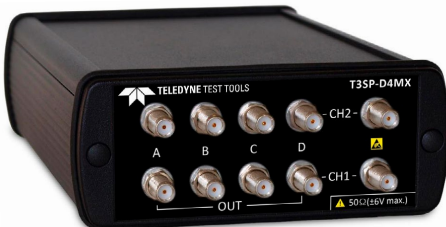
Bild 3. Der T3SP-D4MX von Teledyne ist ein zweikanaliger 1:4-Multiplexer für DC bis 10 GHz, der über eine DLL oder die grafische Benutzeroberfläche WinD4MX.exe gesteuert werden kann.
