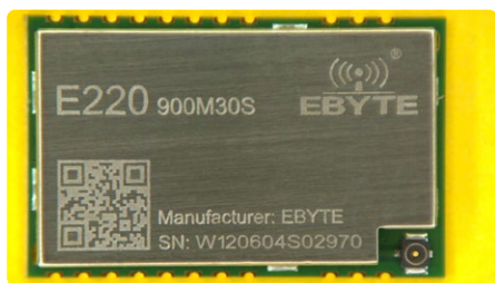
Bild 4. Module mit der Endung „S“ besitzen einen IPEX / U.FL-Antennenanschluss.
