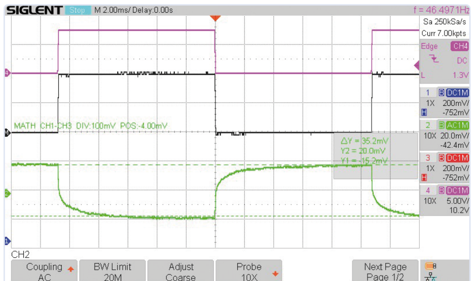
Bild 10. Messung des Innenwiderstands eines gesunden 3-zelligen LiPo-Akkus bei 2 A.
