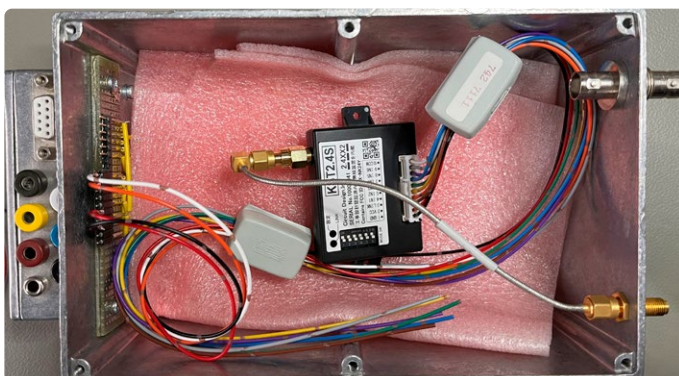
Bild 5. KST2.4S im abgeschirmten Gehäuse.
