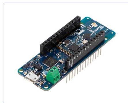
Bild 5. Modul MKR FOX 1200 von Arduino für die Kommunikation im Sigfox-Netzwerk.
