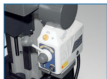
CODE 40026 POWER: Avanzamento automatico longitudinale meccanico della tavola Mechanical longitudinal cross-table feed
