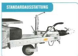
**Kräftiges Stützrad.** 3500 kg mit Rippen. **Kugelumlaufkupplung** mit Schloß bei 3500 kg Modellen
