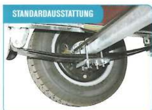
STANDARD-AUSSTATTUNG Parabelfedern sichern hohen Komfort und Robustheit.
