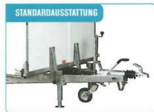
4 kräftige Stützbeine und kräftiges Stützrad. 752 DK2 hat 2 leichte Stützbeine und gewöhnliches Stützrad.
