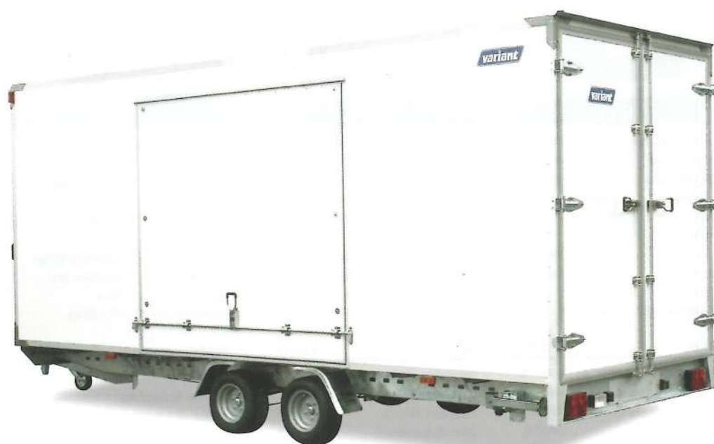
SEITENTÜR Drehstangenverschluss sorgt für dichten Verschluss.
