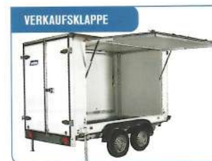
VERKAUFSKLAPPE Große Öffnung in der Seite mit sturmgesicherten Stoßdämpfern.
