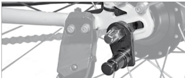
**Conseil :** si la place manque pour monter une attache sur axe ou si le filetage de l'axe plein est trop court, vous pouvez utiliser l'attache sur axe plein Click & Crooz disponible en accessoire, qui vient en remplacement de l'écrou d'axe plein d'origine.
