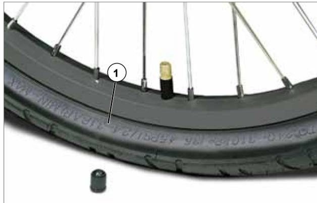
Controle periódicamente los neumáticos para detectar posibles daños y comprobar que la profundidad del perfil es suficiente. Unos neumáticos desgastados o dañados pueden afectar a la conducción del vehículo o incluso reventar, lo que podría causar accidentes con lesiones graves o la muerte.
