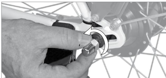
2. Coloque el enganche de eje (3) en el eje sin retirar la arandela de seguridad.
