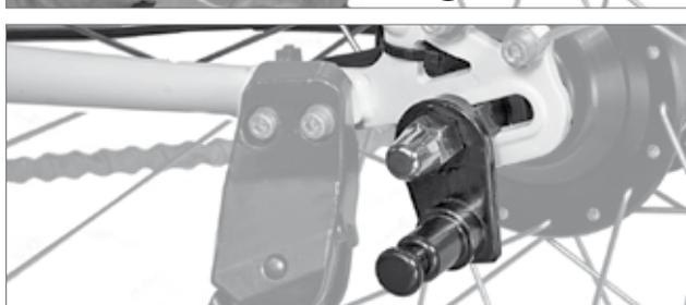
**Sugerencia:** si no hubiera sitio para montar el enganche de eje o si la rosca del eje macizo fuera demasiado corta, puede utilizar el cierre rápido con enganche Click & Crooz® integrado, disponible como accesorio opcional, que sustituye a la tuerca del eje existente.
