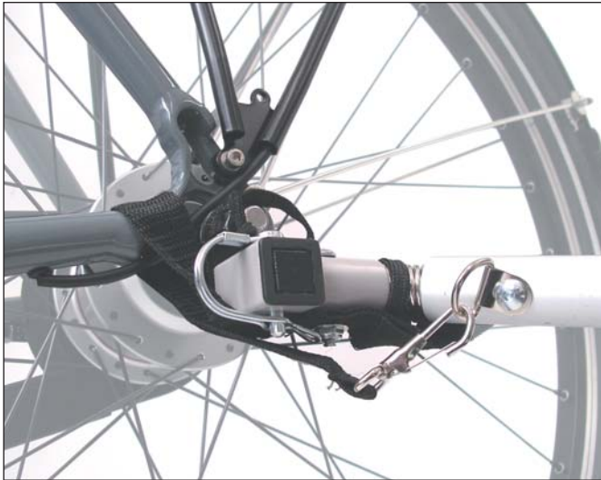
Compleet gemonteerde dissel
