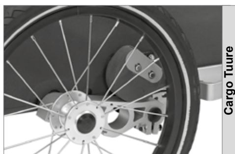
Bezapgopes AirPad® amortizācijas sistēma ar Sylomer® (Cargo Tuure)
