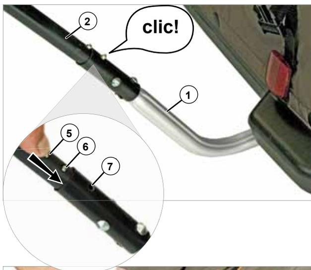
4. Essayez d'extraire le guidon afin de vérifier qu'il est verrouillé correctement.
