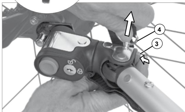
3. Avvolgi il nastro di sicurezza (5) fissato sul timone intorno alla forcella inferiore e rimetti il perno (4) nel foro fino a quando non scatta udibilmente. Tira leggermente per assicurarti che il perno sia incastrato perfettamente. Accertati che non sussista il rischio che il nastro di sicurezza del timone (5) si impigli nei raggi o nei dischi del freno della bicicletta da traino.
