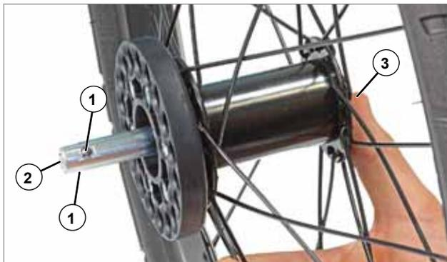
**Nota bene:** *l'asse può essere lubrificato utilizzando un lubrificante per catene di bicicletta..*
