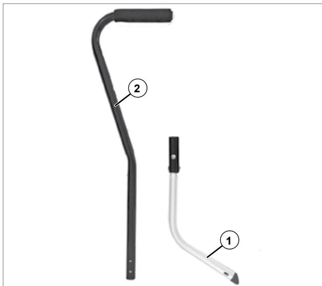
2. Insérez la partie cintrée (1) tournée vers le haut et avec le perçage (3) côté extérieur dans le support de fixation du guidon (4) (identifiable grâce à l'autocollant d'avertissement) jusqu'à ce qu'elle se verrouille dans son logement (4). Au verrouillage, vous devez sentir et entendre un déclic.
