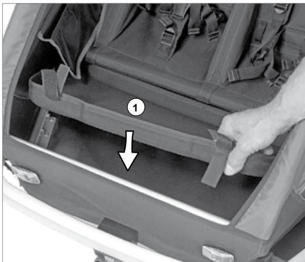
3. Coloque las cintas de velcro (3) alrededor del tubo del bastidor (2) y ciérrelas.
