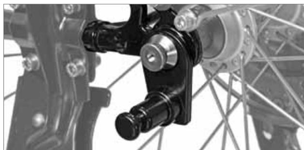
**Conseil :** si la place manque pour monter une attache sur axe ou si le filetage de l'axe est trop court, vous pouvez également utiliser le blocage rapide à attache Click & Crooz® intégrée disponible en accessoire, qui vient en remplacement du blocage rapide d'origine.
