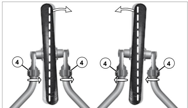
3. Pour démonter le kit jogging, répétez les étapes dans l'ordre inverse. Pressez les boutons (5) au niveau des pattes et extrayez la roue par le bas.
