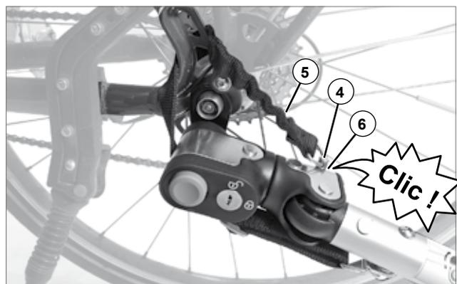
**Conseil :** il est possible de régler la longueur de la sangle de sécurité. La sangle de sécurité doit être réglée aussi court que possible, afin d'éviter tout contact entre elle et les rayons, le moyeu ou le frein à disque. Lors d'une utilisation du Croozer avec un autre vélo, vérifiez la longueur de la sangle de sécurité.
