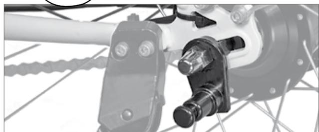
**Conseil :** si la place manque pour monter une attache sur axe ou si le filetage de l'axe plein est trop court, vous pouvez utiliser l'attache sur axe plein Click & Crooz® disponible en accessoire, qui vient en remplacement de l'écrou d'axe plein d'origine.
