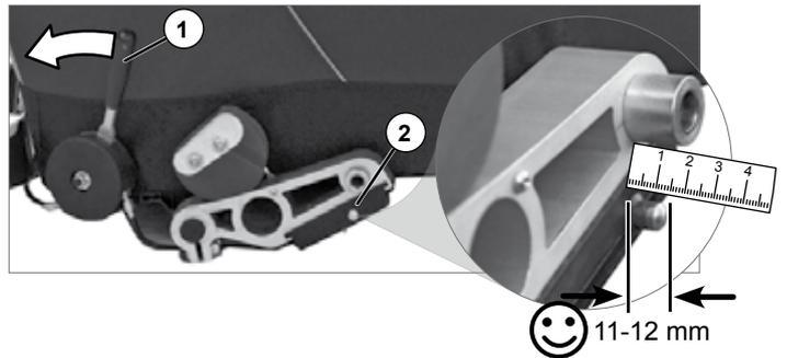
3. Mesurez à l'aide d'une règle de combien les ergots dépassent des étriers. Le frein de stationnement est correctement réglé si les ergots dépassent de 11 à 12 mm.
