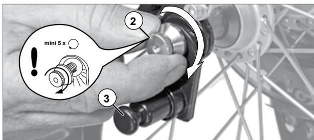
5. Contrôlez l'alignement de la roue arrière puis poussez le levier de serrage du blocage rapide vers le cadre. Souvent, le sens du mouvement du levier de serrage est indiqué par le terme « CLOSE ». La force utilisée doit augmenter environ à mi-course. Dans la dernière moitié de sa course, manœuvrer le levier de serrage devrait demander un effort important. En position finale, le levier doit être parallèle au cadre et non former un angle par rapport à lui.
