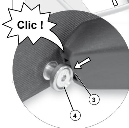
2. Positionnez l'écrou molleté (2) sur le goujon (5) et positionnez-le correctement dans le perçage du cadre. Pendant cette opération, maintenez le pare-chocs en appui contre le cadre afin qu'il conserve sa position correcte. De l'autre main, vissez ensuite au contact l'écrou molleté (2) jusqu'en butée.
