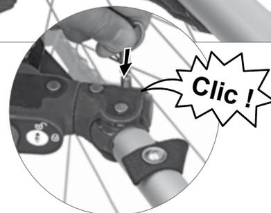
4. Pour empêcher le vol ou un détachement non autorisé du Croozer, la tête du timon est équipée d'une serrure qui fait office d'antivol entre la remorque et le vélo tracteur. Cela permet de sécuriser la connexion du Croozer au vélo tracteur.
