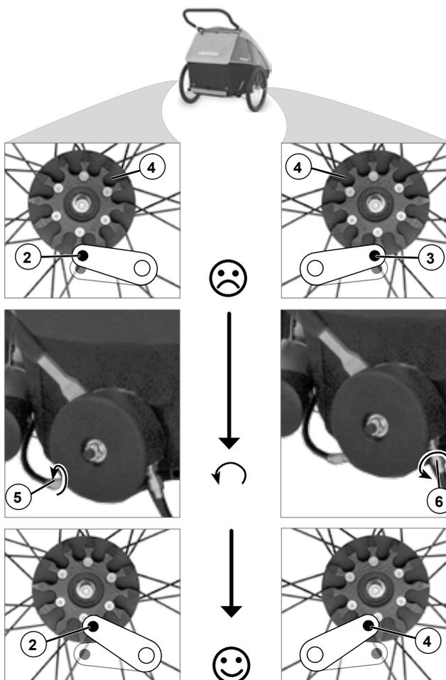
3. Si l'ergot (2) du côté gauche du Croozer ne s'engrène pas complètement dans le disque denté (4), vous devez tourner dans le sens antihoraire la butée fileté (5) au niveau du levier de commande jusqu'à ce que l'ergot (2) s'engrène totalement dans le disque denté (4).
