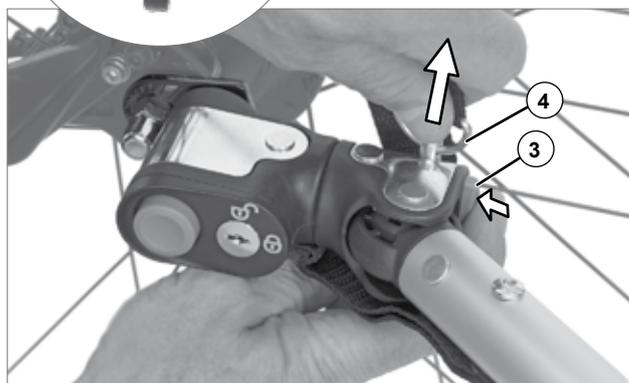
3. Faites passer la lanière de sécurité (5) autour de la base et insérez à nouveau la goupille (4) dans son perçage, en contrôlant le verrouillage à l'oreille et de visu. Exercez une légère traction pour vous assurer que la goupille est bien verrouillée. Veillez à ce que la sangle de sécurité (5) ne puisse se prendre dans les rayons ou les freins à disque.
