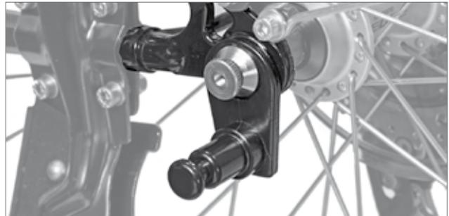
Si le levier de serrage ne se laisse pas fermer entièrement, ouvrez le levier de serrage et dévissez l'écrou de serrage en faisant un demi-tour dans le sens antihoraire. Répétez les étapes 5 et 6. Veillez à ce que l'écrou soit serré d'au moins cinq tours complets sur la tige filetée du blocage rapide.
