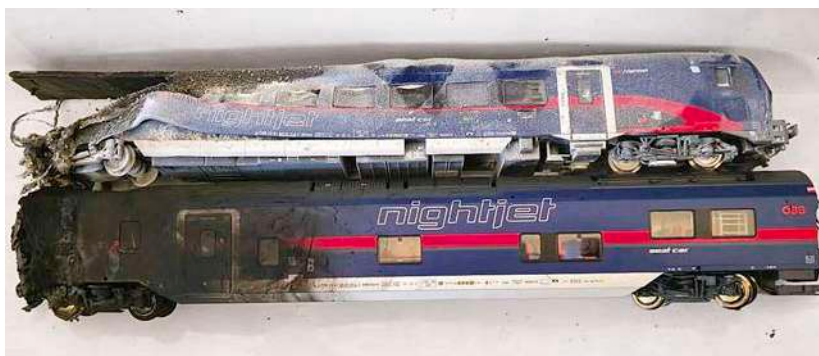
Der H0-Nightjet-Zug von Roco in der Digitalversion wurde aufgrund auftretender Überhitzungsschäden zurückgerufen. Die betroffenen Fahrzeuge werden derzeit beim Hersteller untersucht und repariert
