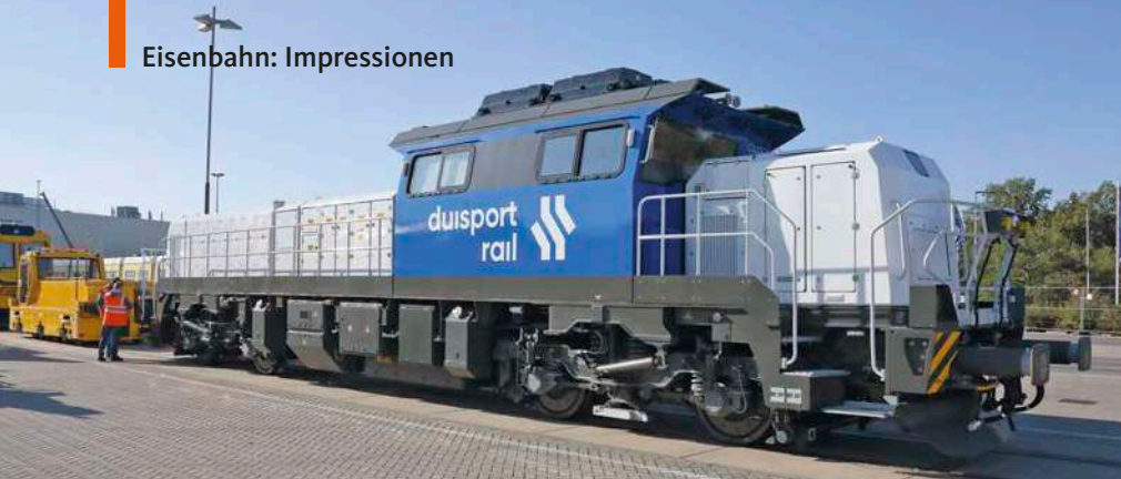
Vossloh Rolling Stock präsentiert zusammen mit Duisport Rail als neue Variante der Modula-Lokomotive die Version BFC mit Wasserstoffantrieb
