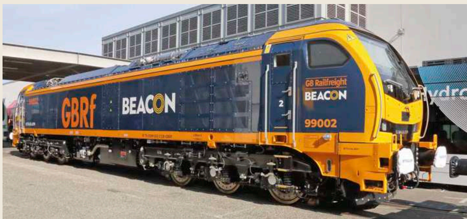
Die Class 99 von Stadler basiert auf der Eurodual-Linie, ist aber an das britische Umgrenzungsprofil angepasst und somit schmaler und niedriger als ihre kontinentalen Schwestern
