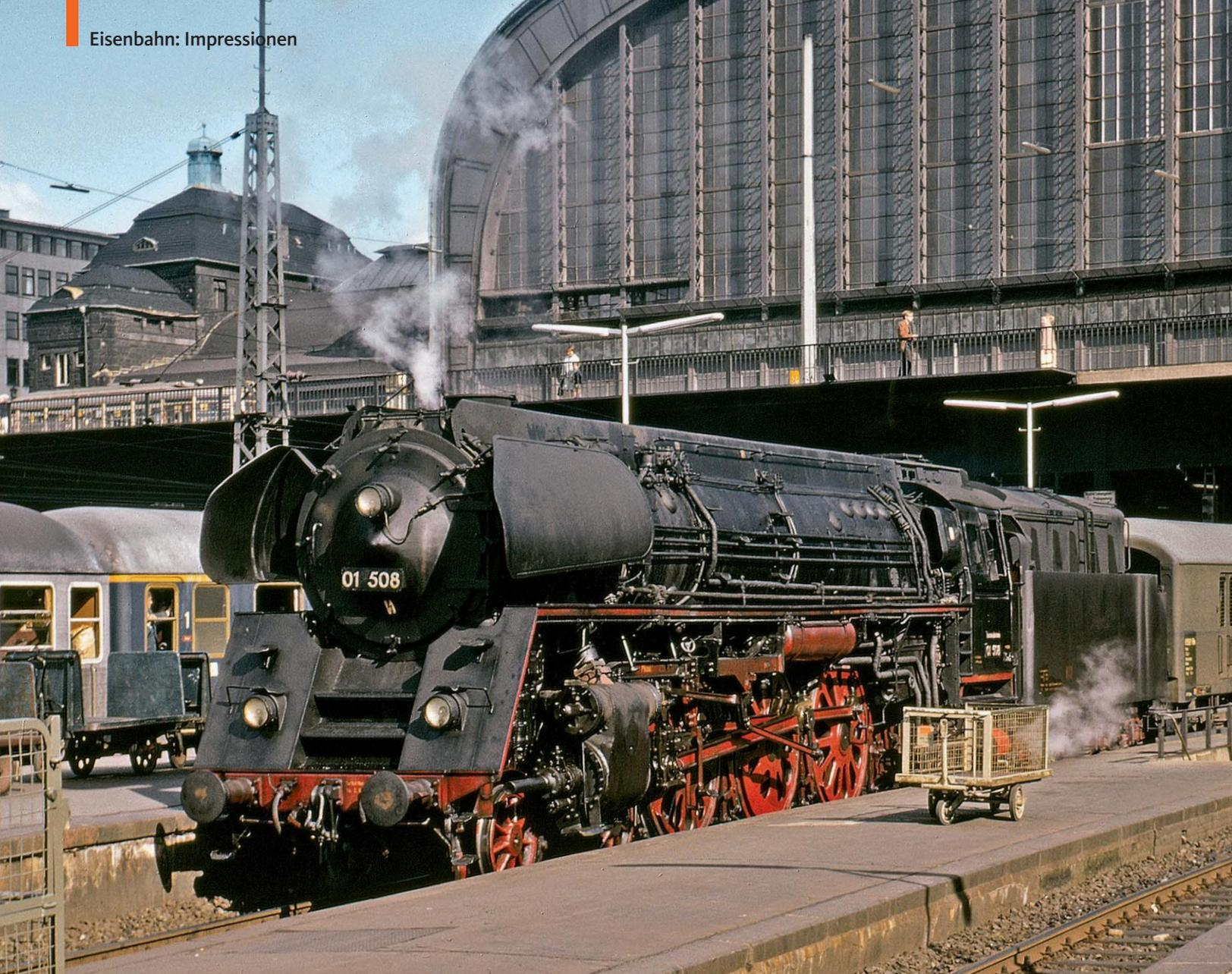
Die Schnellzugdampflok der Baureihe 01<sup>5</sup> waren das Aushängeschild der Rekonstruktion schlechthin: Mit der Verkleidung um Schornstein und Dom, speziellen Windleitblechen und Verschiedenem mehr unterstrichen die Konstrukteure die Ertüchtigung der Original-01. Herzstück der Rekonstruktion war und blieb freilich der neue, dampffreudige Kes-
