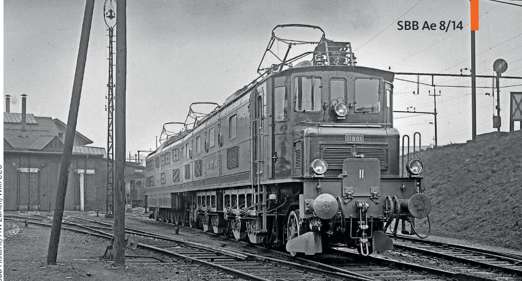
Heute wie einst imposant steht die SBB Ae 8/14 11801 mit der Kraft von 5.200 kW in der für sie in der Folgezeit zuständigen Hauptwerkstätte Zürich am 21. Januar 1932
