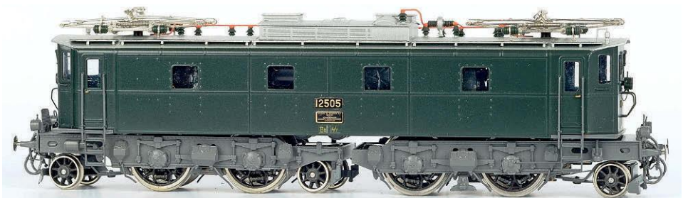
Die Be 4/7 mit Westinghouse-Antrieben und ihrem (1'Bo1')(Bo1')-Drehgestell-Fahrwerk als HO-Modell von Fulgurex
