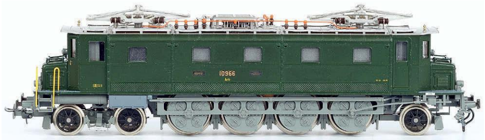
Die Ae 4/7 mit Buchli-Antrieben und 2'Do1'-Fahrwerk bildete den Ausgangspunkt für die Ae 8/14 11801, hier als HO-Modell von Liliput
