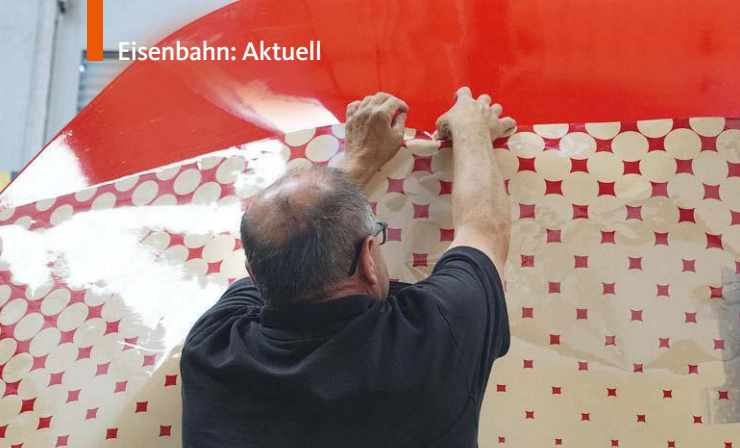
Provisorisch heftet Klaus Hunger eine Folie an, um sie leichter ausrichten zu können
