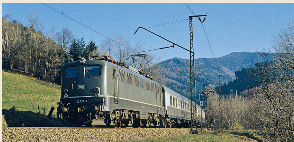
Nach der 145 wickelt die Baureihe 139 (E 40 mit elektrischer Widerstandsbremse) den Betrieb auf der Höllental- und Dreiseenbahn ab; Foto bei Hinterzarten, 1993
