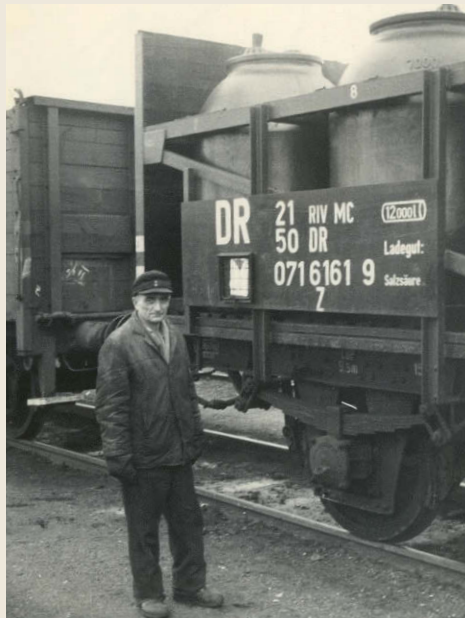
Rangierer vor einem Topfwagen (Gattung Z) mit Steingutgefäßen zum Transport von Salzsäure aus den Solvay-Werken bei Egel Slg. Kaiß
