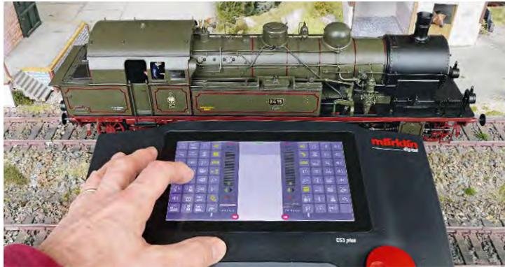
**Loks mit mfx-Decoder melden sich beispielsweise an der CS3 von Märklin vollautomatisch an und ermöglichen – je nach Variante – bis zu 32 schaltbare Funktionen**
