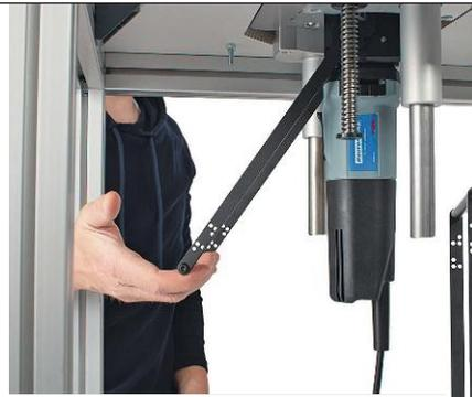
Mit dem Spannhebel spannt man von unten den Fräsmotor in den Frästisch
