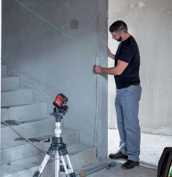
Die Neigungsfunktion schaltet man zu, wenn man etwa eine Treppe plant und ausmisst
