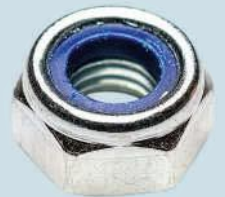
Der Kunststoffring in Sicherungsmuttern verhindert, dass sie sich bei Vibration lösen
