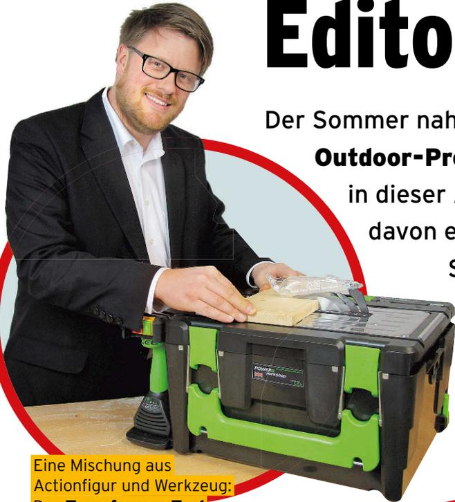
Eine Mischung aus Actionfigur und Werkzeug: Das **Transformer-Tool „Power & Workshop“** lässt sich vom Koffer in eine Tischkreissäge, eine stationäre Stichsäge und in eine Bohrstation mit Bohrständler verwandeln. Was es wirklich taugt, haben wir getestet - nachzulesen auf Seite 34.
