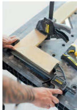
Dank der Schlitze im Tisch lassen sich Werkstücke in nahezu jeder Position fixieren
