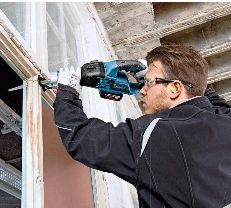
Der vordere Schaft der Säge ist schmal und lässt sich leicht mit der Hand umfassen
