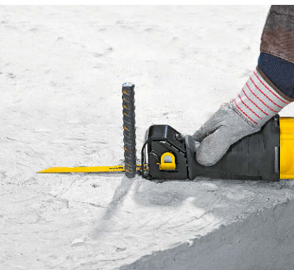
In dieser Position lässt sich das Sägeblatt nahe am Boden entlang führen
