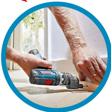
Der Exzenteraufsatz ermöglicht ein exaktes, randnahes Schrauben. Man kommt bis 12 mm an die Kante heran. Es sind 16 Arbeitspositionen einstellbar, ohne dass man dabei den Aufsatz vom Akku-Bohrschrauber lösen muss
