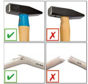
Oben links: optimale Ausstattung mit Stiel-schutz und Stielbruch mit Hickory-Holz. Oben rechts: Schadens-bild ohne Schutz und ein gebrochener Stiel
