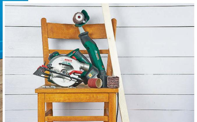
**Das Werkzeug:** Der Zuschnitt der Stühle gelingt am besten mit einer Handkreissäge. Das Abschleifen ist mit einem Schleifroller schnell erledigt.
