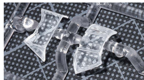
Glasklare Probleme im Uhrzeigersinn: Orangenhaut bei eduard, Fließnähte bei Airfix, Riefen bei Hasegawa und Polierabbruch bei Revell
