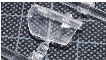
Glasklare Probleme im Uhrzeigersinn: Orangenhaut bei eduard, Fließnähte bei Airfix, Riefen bei Hasegawa und Polierabbruch bei Revell
