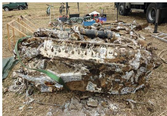
Der Motor hat sich über vier Meter tief in den lehmigen Boden gebohrt und entpuppte sich als Zwölfzylinder-V-Motor Jumo 213A-1, der die Fw 190 D-9 antrieb
